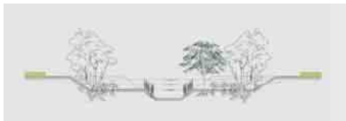
Fig. 3-7 - Risezionamento di alveo con inserimento di vegetazione su entrambe le sponde
