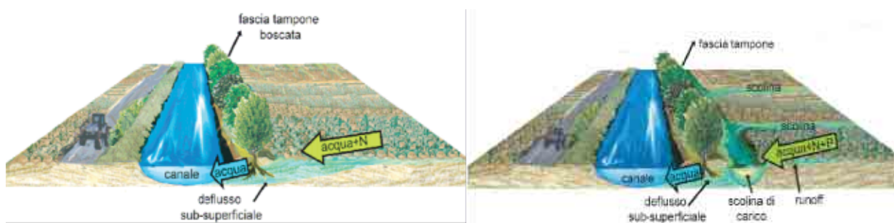
Figura 2.12 - Attraverso la diversificazione della progettazione (solo fasce tampone arboree o in abbinamento con fasce erbacee e scoline di carico) è possibile massimizzare la resa depurativa per diversi tipi di inquinanti. (da PTA Provincia Bologna)
