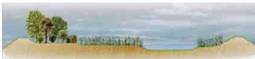
Fig. 3-8 - Esempio di risezionamento con inserimento di vegetazione solo su una sponda
