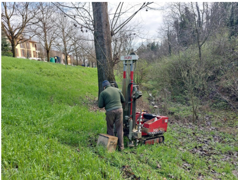
Foto 3 – Prova penetrometrica statica CPT3 area piede paramento lato valle
