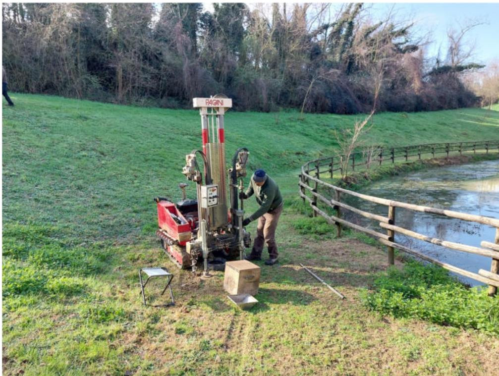
Foto 2 – Prova penetrometrica statica CPT2 area piede paramento lato monte
