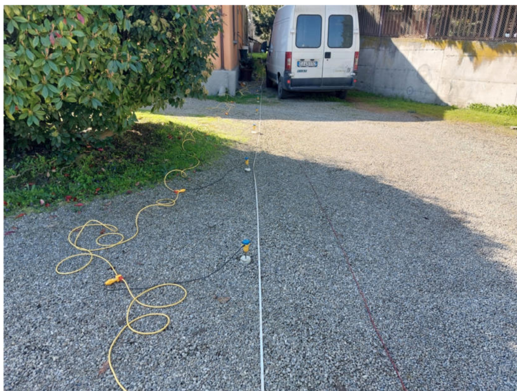
Foto 10 – Stendimento sismico in tecnica MASW area poligono di tiro
