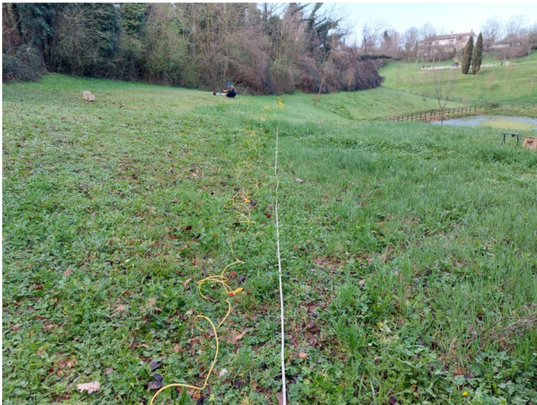
Foto 8 – Stendimento sismico in tecnica MASW
