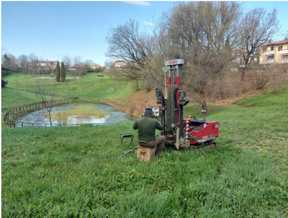
Foto 1 – Prova penetrometrica statica CPT1 (coronamento)
