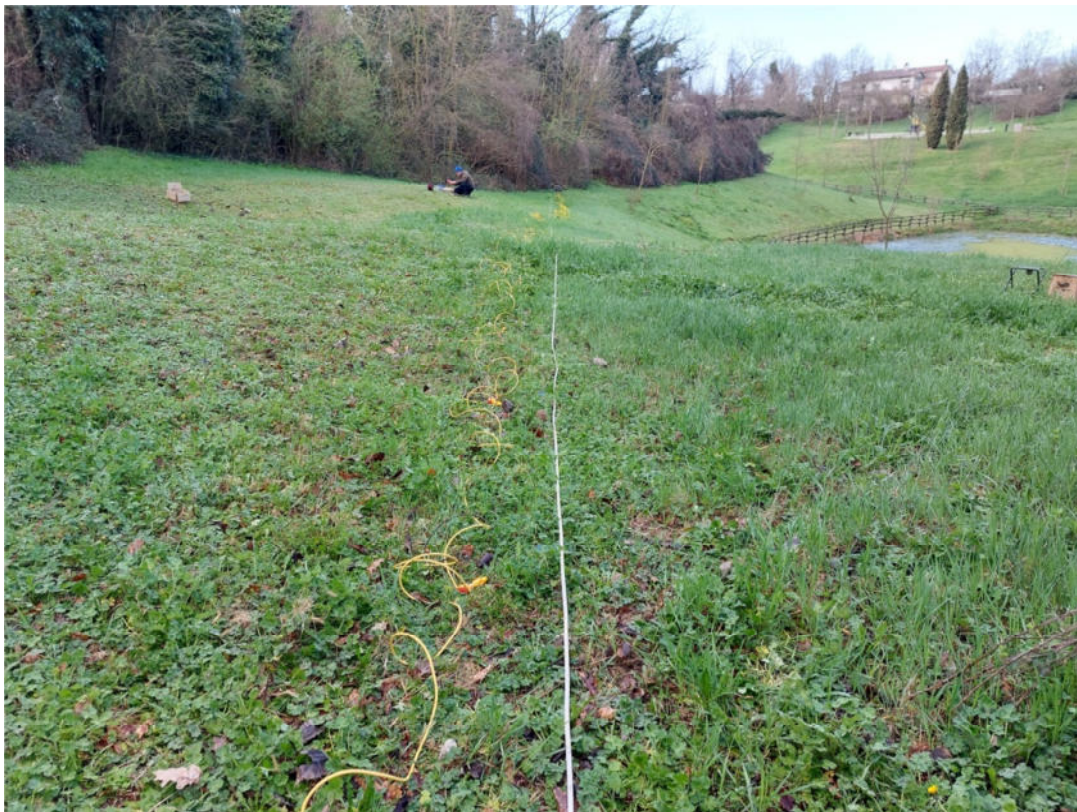
Foto 8 – Stendimento sismico in tecnica MASW
