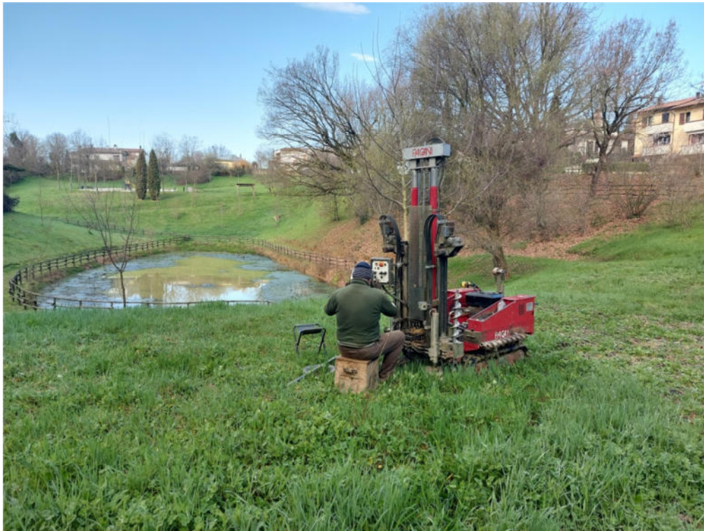
Foto 1 – Prova penetrometrica statica CPT1 (coronamento)
