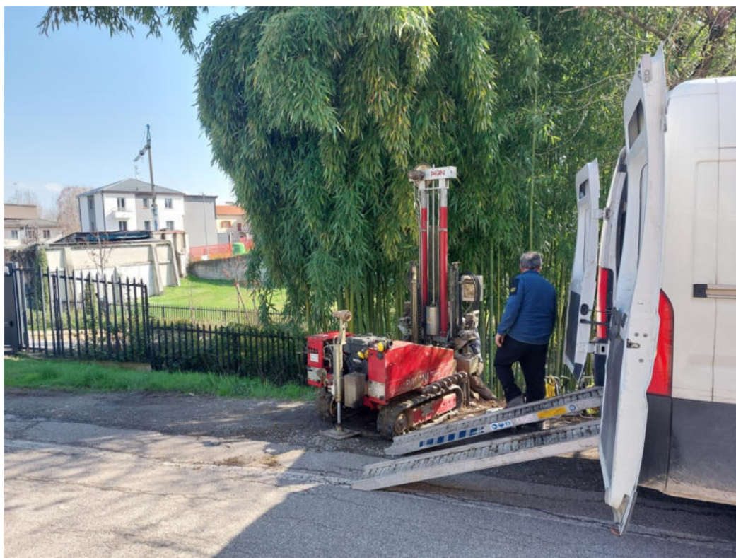
Foto 11 – Prova penetrometrica statica CPT5 (Via Carnevali)
