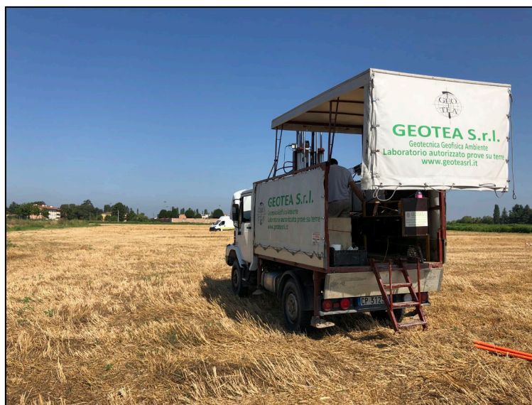
Foto 6 – Esecuzione Prova CPTu6.
