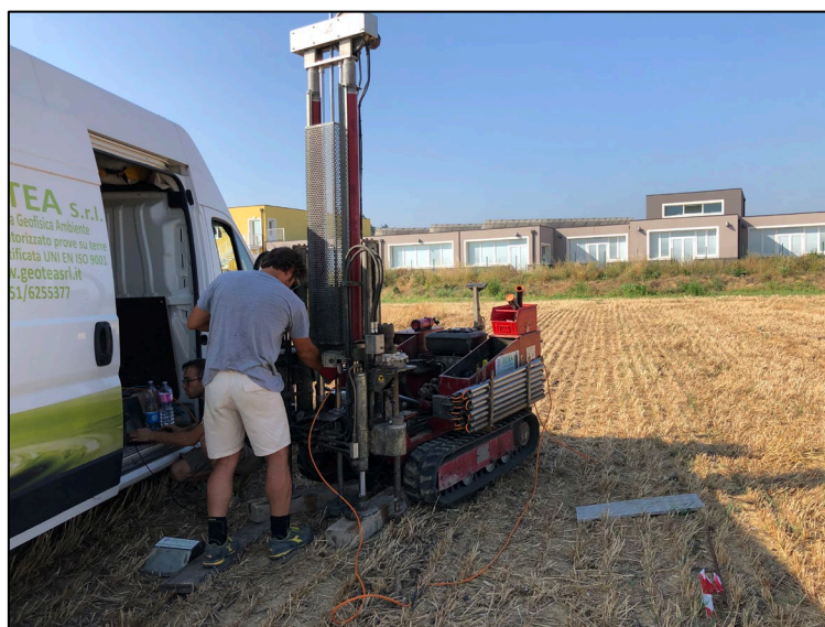
Foto 2 – Esecuzione Prova CPTu2.
