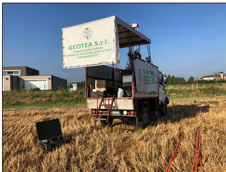
Foto 3 – Esecuzione Prova CPTu3.
