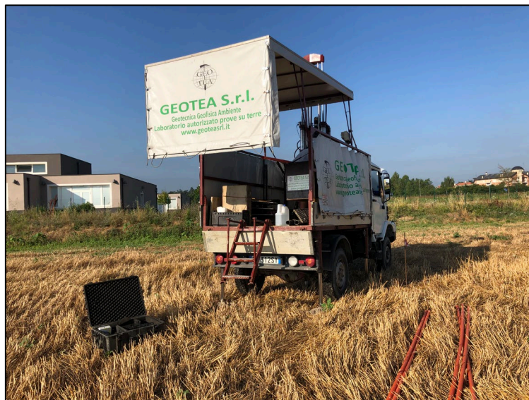
Foto 4 – Esecuzione Prova CPTu4.
