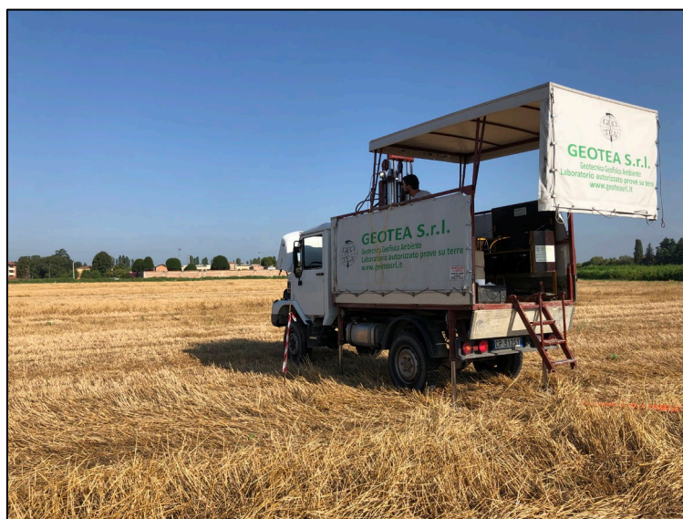
Foto 5 – Esecuzione Prova CPTu5.
