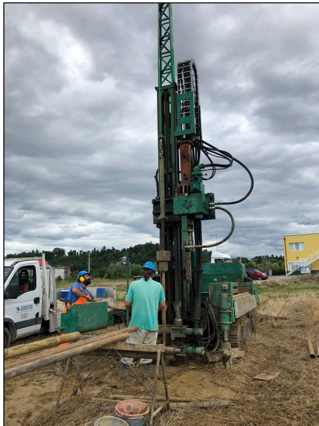
Foto 14 – Sondaggio S1. Esecuzione prova SPT2.
