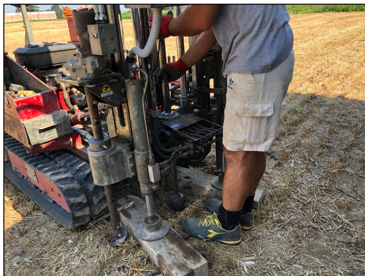
Foto 8 – Prelievo del campione CPTu1-C1.
