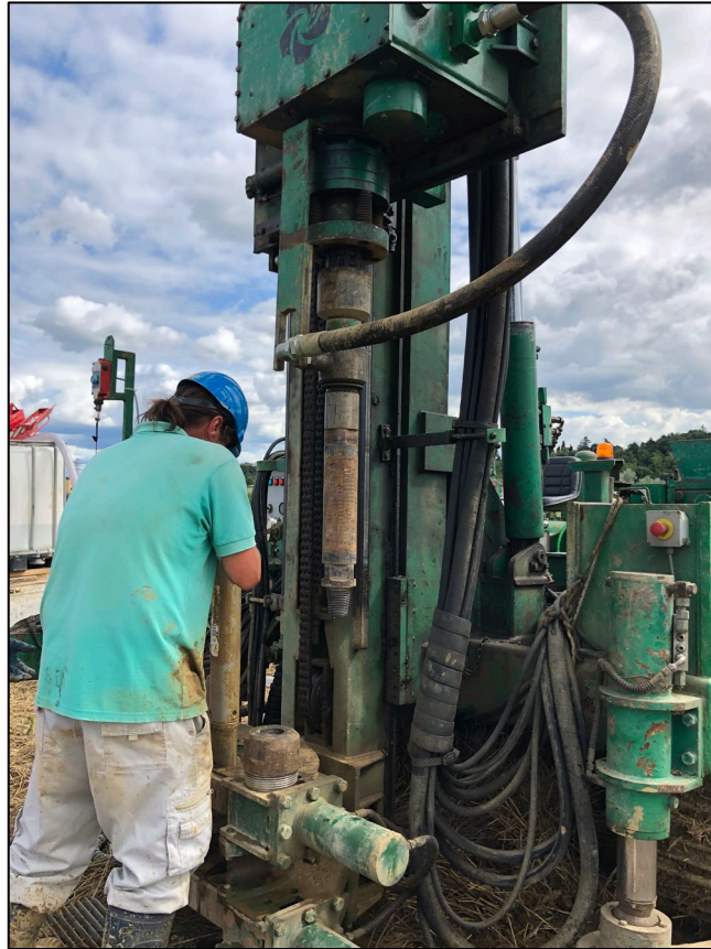
Foto 13 – Sondaggio S1; esecuzione prova SPT1
