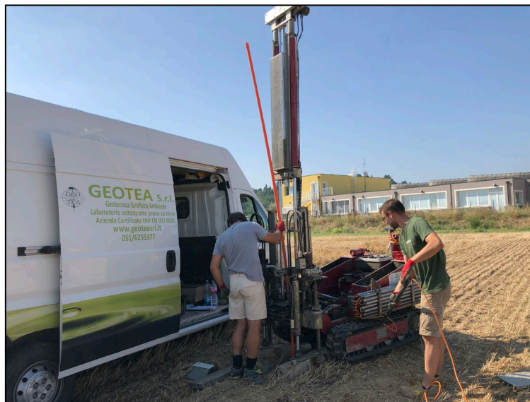
Foto 7 – Esempio di installazione di tubo per il rilievo della falda superficiale nella Prova CPTu2.
