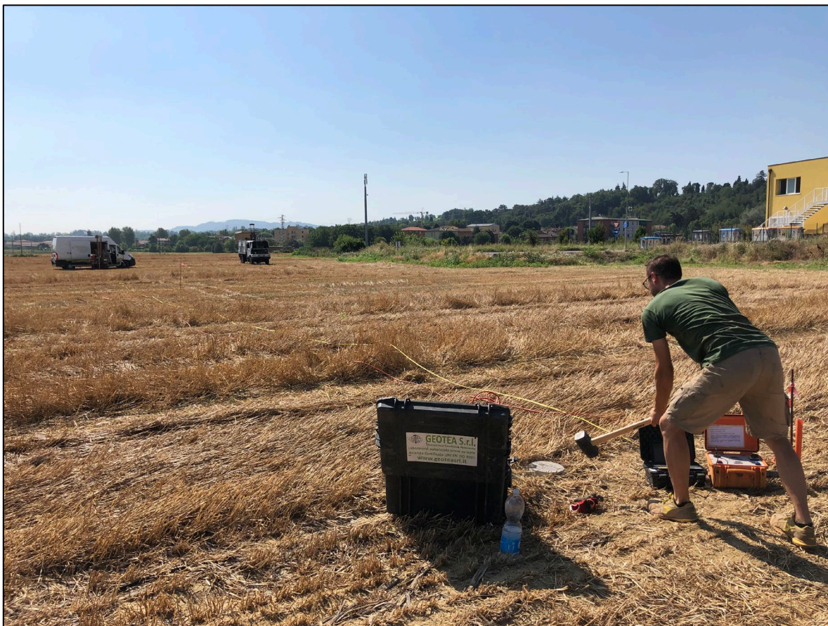
FOTO 1 - ESECUZIONE INDAGINE GEOFISICA MASW-REMI.
