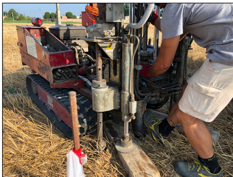
Foto 9 – Prelievo del campione CPTu3-C3.
